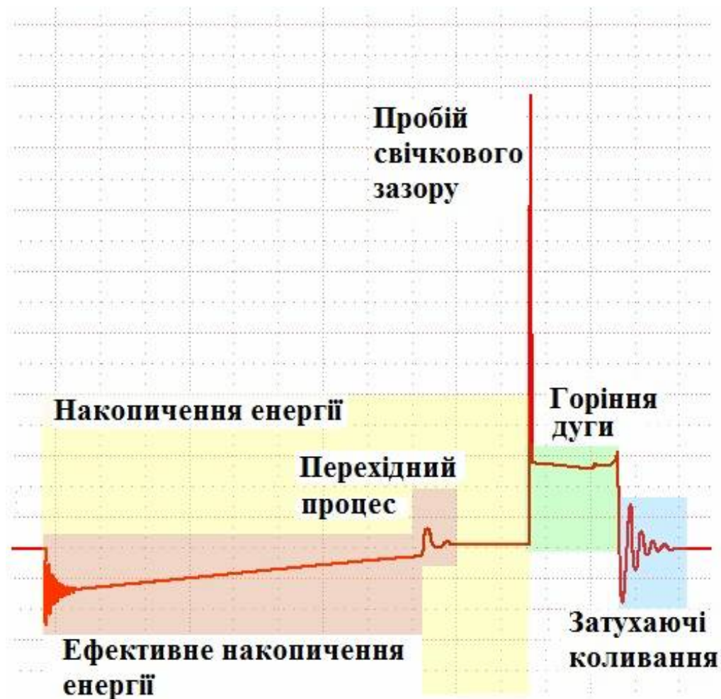
Рис. 2 – Осцилограма вторинної напруги справної системи запалювання
