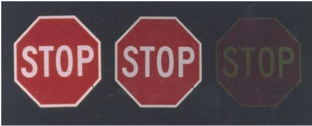
Рис. 2.2. Зразки знаків через 1 рік експлуатації (ліворуч та у центрі - знак із новою плівкою LG, праворуч - знак із плівкою старого «інженерного» зразку)
