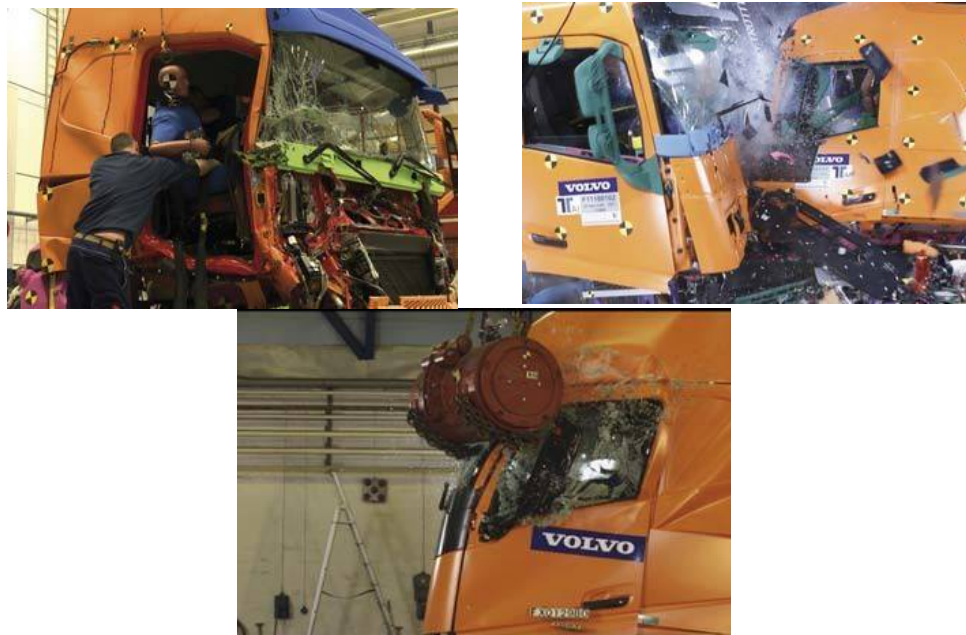
Рис. 1.5 – Приклади кабін після натурних випробувань
