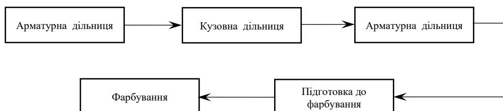
Рис. 2.1. Схема переміщення автомобіля під час виконання кузовного ремонту
