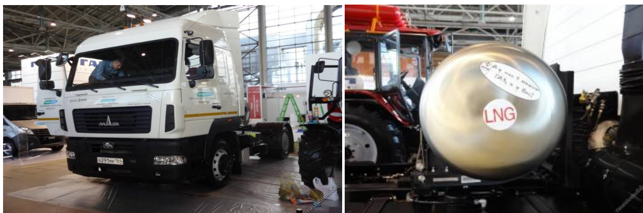
Рисунок 5 - Газобалонна система автомобіля МАЗ-536 на зрідженому метані
