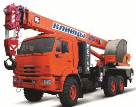
Рисунок 6 - Автокран моделі КС-55713-5К-1 з двигуном на стиснутому метані
