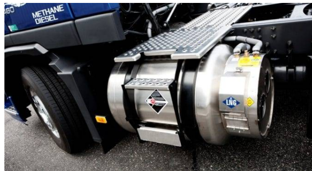
Рисунок 2 – Автомобіль Volvo-460 на зрідженому метані
