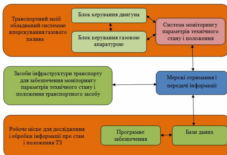
Рисунок 3.2 - Схема інформаційного обміну між елементами системи вимірювань для здійснення дистанційного дослідження роботи ТЗ, обладнаного системою впорскування газового палива в умовах експлуатації засобами ITS
