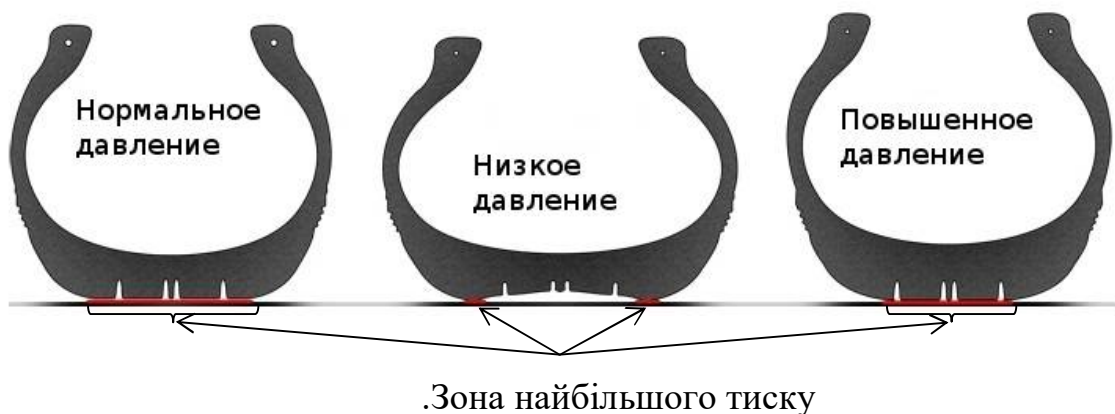
Рисунок 1.2 - Пляма контакту шини з поверхнею в залежності від тиску в ній [13]
