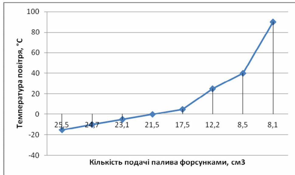
Рисунок 3.6 – Графік залежності витрати палива на початку пуску двигуна, залежно від температури навколишнього середовища
