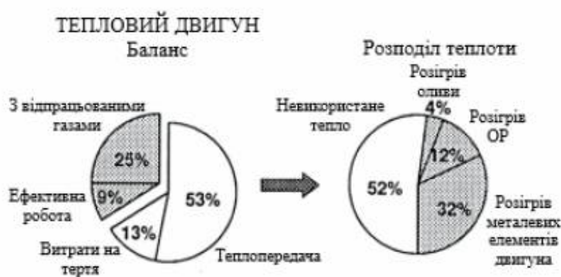
Рисунок 1.3 – Енергетичний баланс бензинового ДВЗ в режимі прогрівання.
