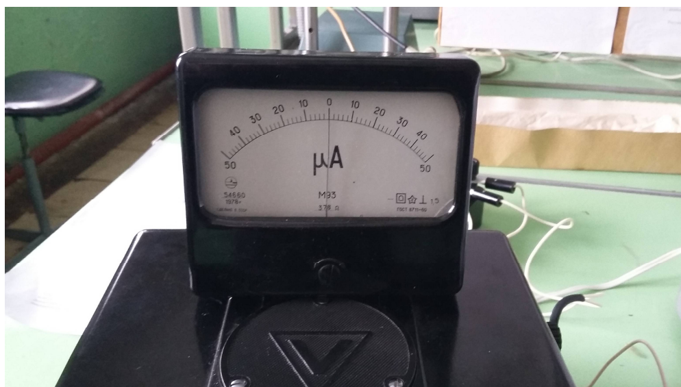
Рисунок 5. Міліамперметр фотоелектроколориметру ФЕК-М
