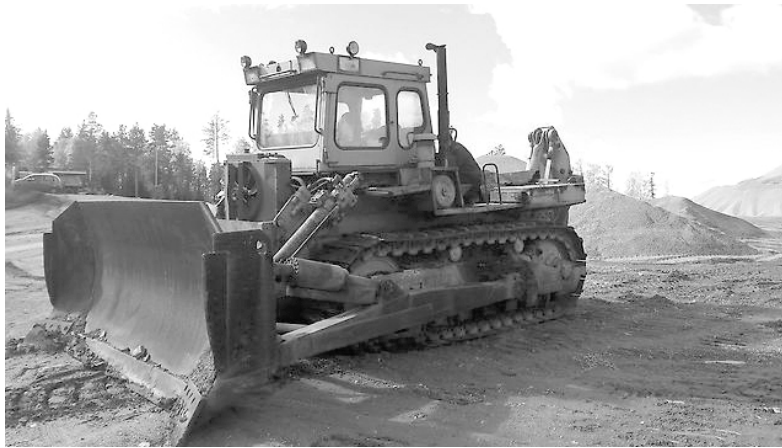
Рисунок 3.1 – Загальний вигляд промислового трактору Т-330, обладнаного бульдозерним відвалом
