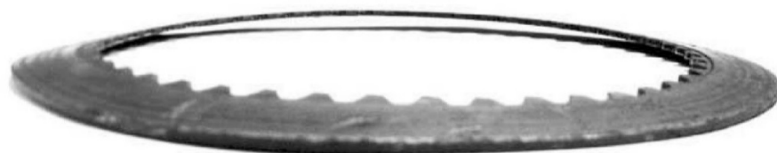
Рисунок 1.5 – Викривлення та відшарування фрикційних накладок диску тертя
