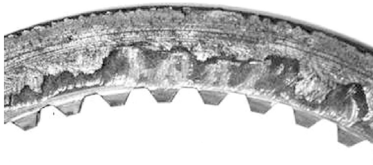
Рисунок 1.4 – Зношування при фреттинг-корозії фрикційного диску
