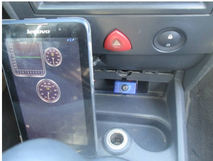
Рисунок 2.2 – Обладнання для моніторингу автомобілів у режимі реального часу
