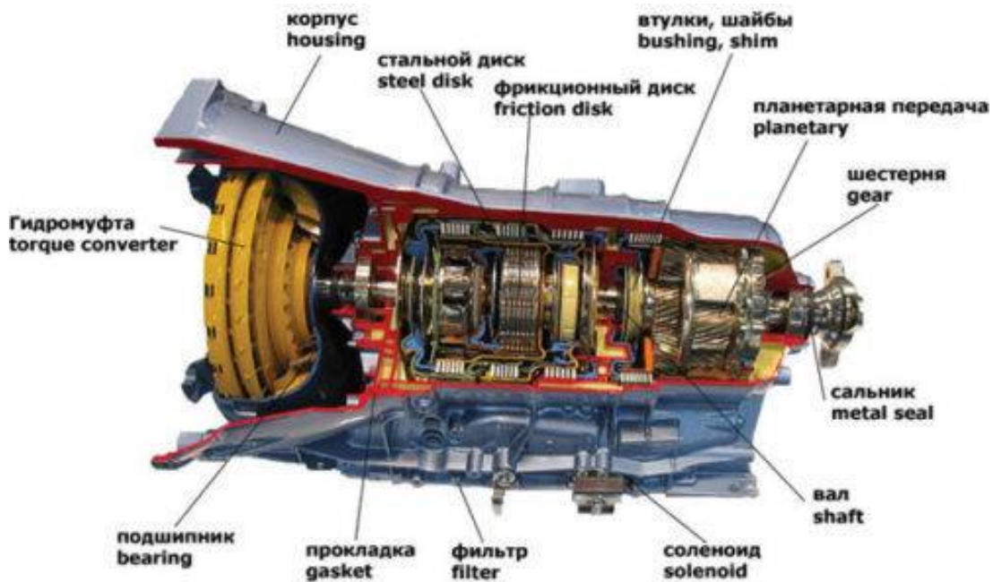
Рисунок 1.5 – Розріз АКПП ZF 5HP19
