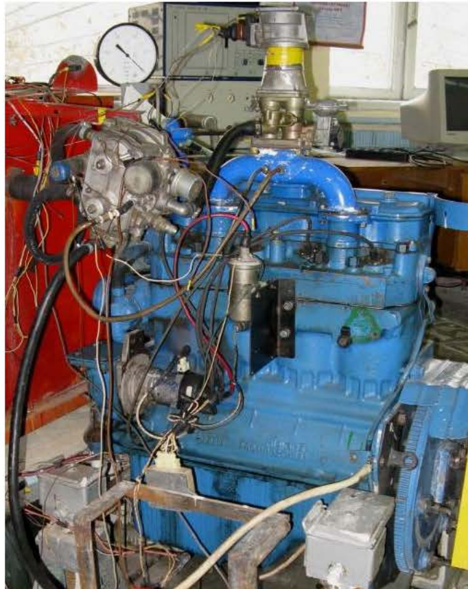
Рис. 2.1 – Переобладнаний з дизеля Д-243 газовий двигун на випробувальному стенді
