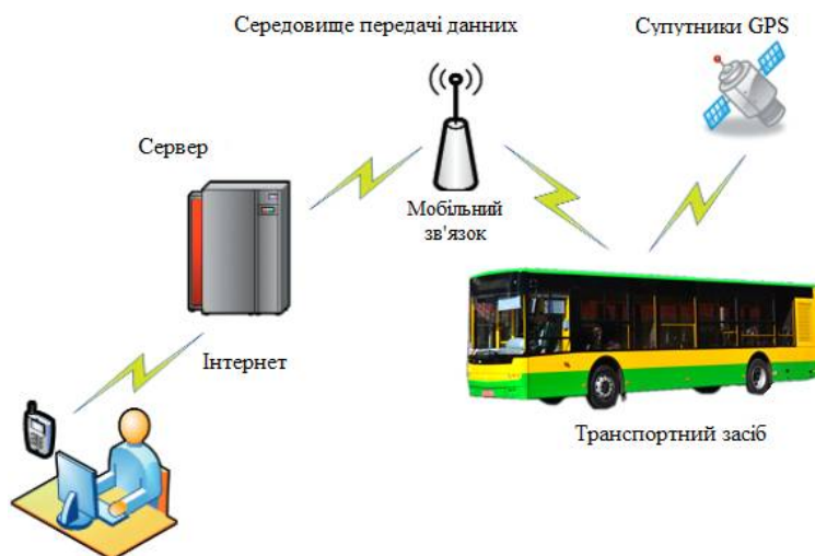
Рисунок 3.2 - Принцип роботи GPS трекера
