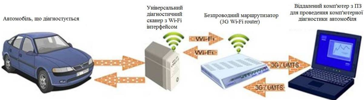
Рисунок 2.3 – Взаємодія між автомобілем і комп'ютером віддаленої діагностики
