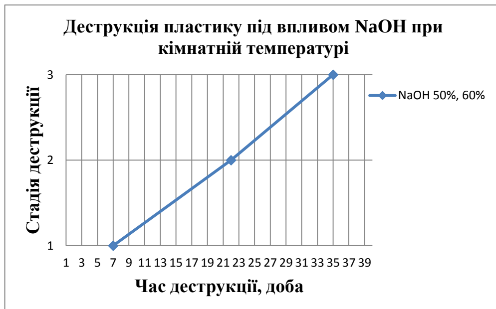
Рисунок 3 - Деструкція ПЕТ-пляшок під дією NaOH при кімнатній температурі
