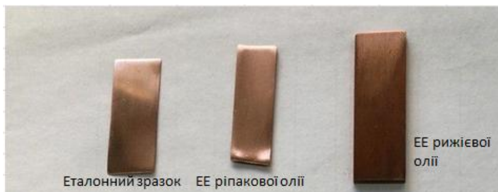
Рис 3.6. Корозія на мідній пластині етилового естеру ріпакової олії та етилового естеру ріжівської олії в порівнянні з еталонним зразком
