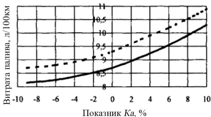
Рис. 2. Розрахункова залежність контрольної витрати палива на швидкості 90 км / год від величини K_a (суцільна лінія - на бензині, пунктирна - на газі)
