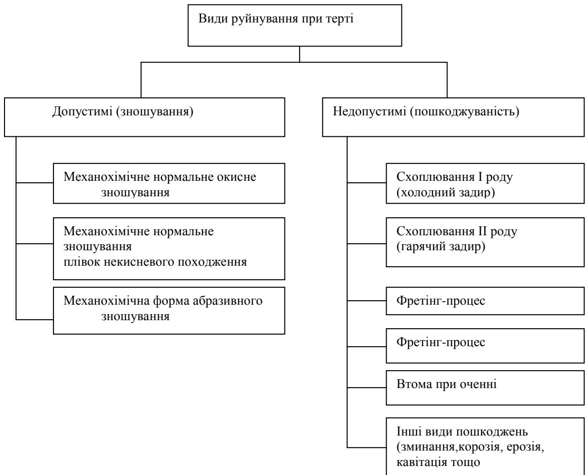
Рис. 1.1. Класифікація видів зношування і пошкоджуваності деталей машин
