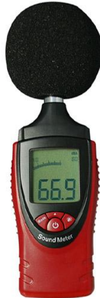
Рис. 3. Прилад для вимірювання рівнів звукового тиску та звуку: шумомір ST8080
