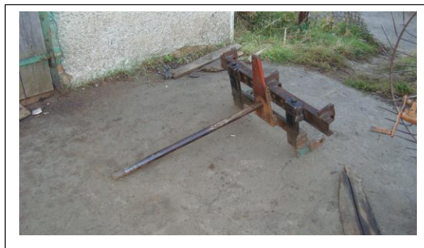
Рис. 3.4. Завантаження зерна у вантажний автомобіль за допомогою навісного обладнання до трактора з ківшом (А), а рулонів соломи – спец. штирем (Б)
