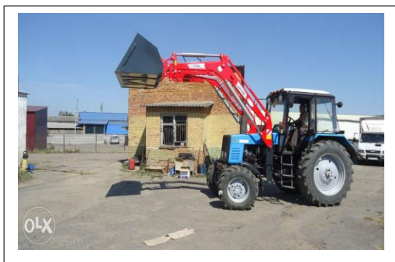
Рис. 3.4. Завантаження зерна у вантажний автомобіль за допомогою навісного обладнання до трактора з ківшом (А), а рулонів соломи – спец. штирем (Б)
