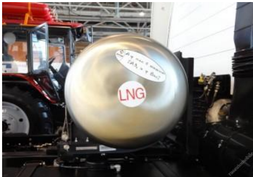
Рисунок 5 - Газобалонна система автомобіля МАЗ-536 на зрідженому метані
