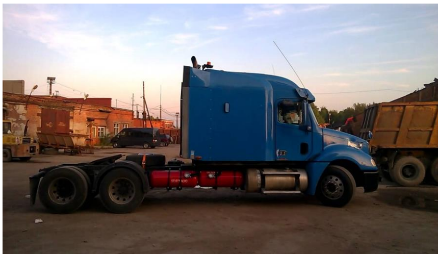
Рисунок 1 - Freightliner 120 на пропан-бутане
