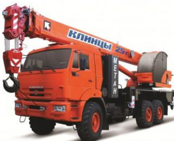
Рисунок 6 - Автокран моделі КС-55713-5К-1 з двигуном на стиснутому метані
