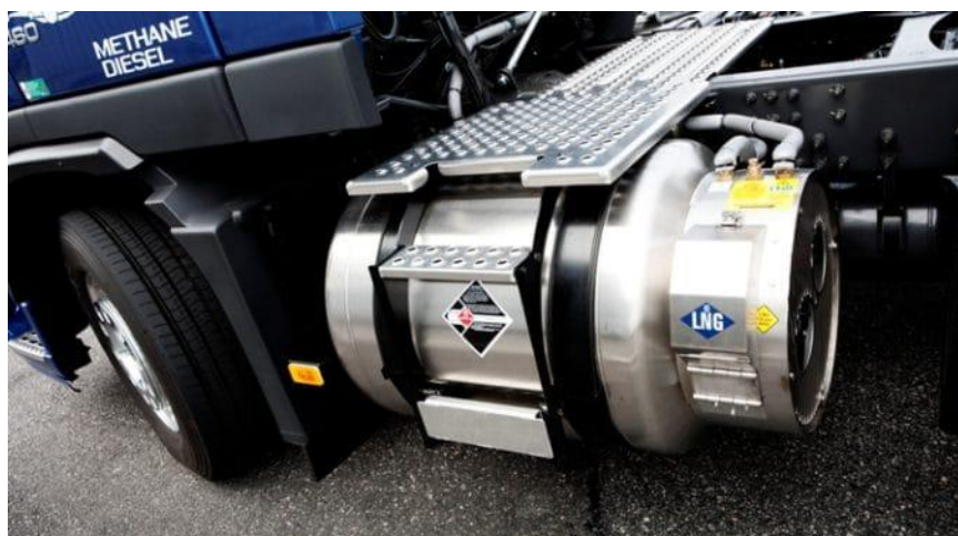
Рисунок 2 – Автомобіль Volvo-460 на зрідженому метані
