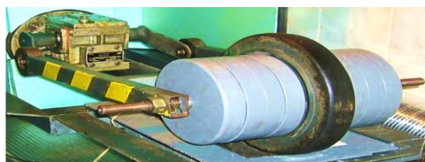
Рисунок 2.3– Електромеханічний Випробувальний Стенд Колієутворення (ЕМВСК ХНАДУ)
