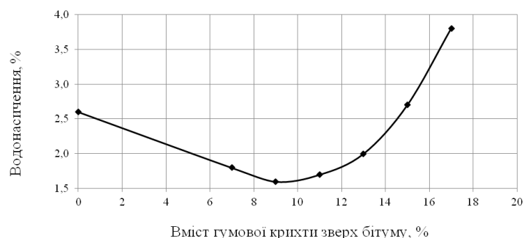
Рисунок 3.1 – Залежність водонасичення від вмісту гумової крихти у складі ЩМА-15
