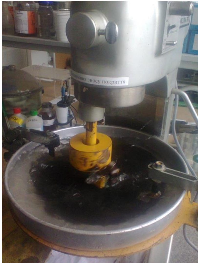
Рис. 6 Процес зносу покриття приладом HOBART
