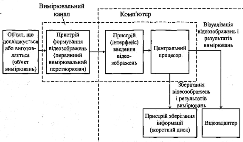
Рис. 3.9. Структурна схема апаратних засобів для відеовимірювань лінійних і кутових переміщень об'єктів
