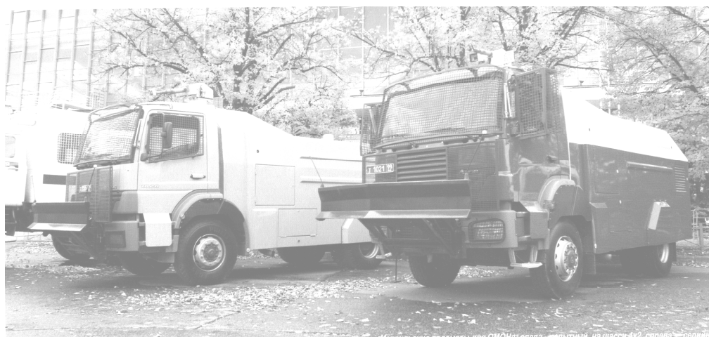
Рисунок 4.4 – Ізраїльські водомети, зліва – дослідний на шасі 4×2, справа повнопривідний і броньований
