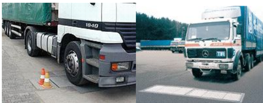
Рисунок 3.1 – Вимірювальна платформа вбудована в дорожнє полотно
