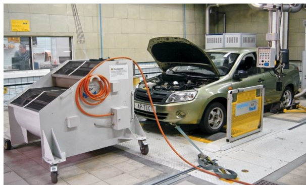
Рисунок 3.2 – Випробування на стенді з біговими барабанами
