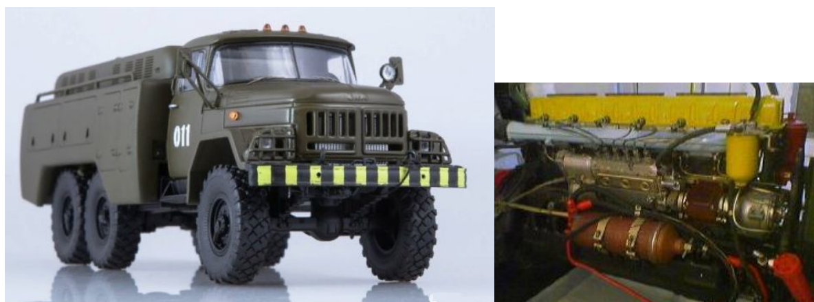
Рисунок 2.2 – Аеродромний пересувний електроагрегат АПА-50М:
