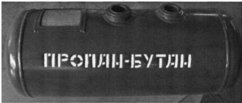
Рисунок 14 – Автомобільний газовий балон з додатковим фланцем:
