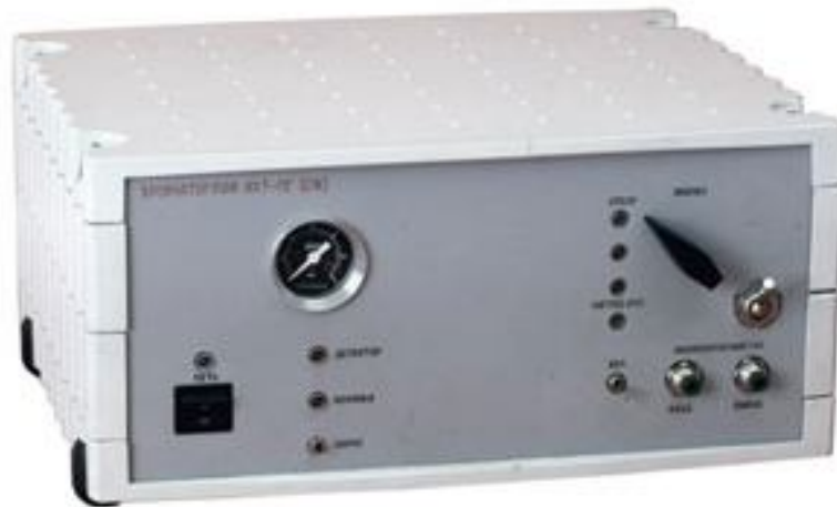
Рисунок 9 – Хроматограф для визначення компонентного складу СВГ АХТ-СЖ
