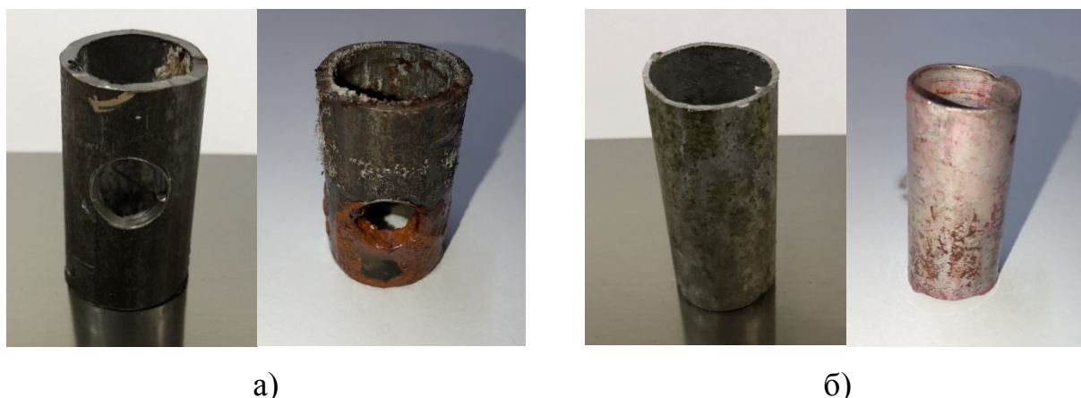
Рис. 6. Зміни дослідних зразків після зберігання протягом місяця: а – фото зразка сталі до та після; б – фото зразка алюмінію до та після
