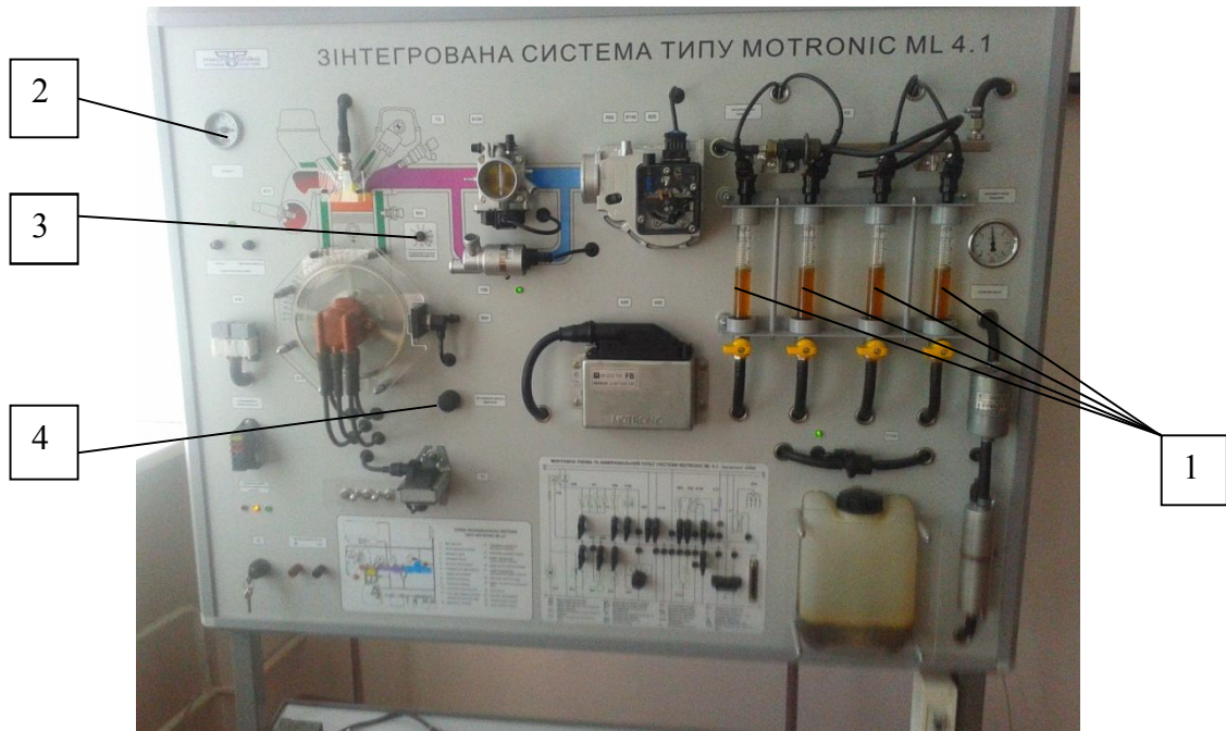
Рисунок 3.3 - Загальний вигляд стенду електронної системи «Мотронік»: 1 – мірні пробірки; 2 – тахометр; 3 – регулятор температурного режиму двигуна; 4 – регулятор обертів колінчастого вала.
