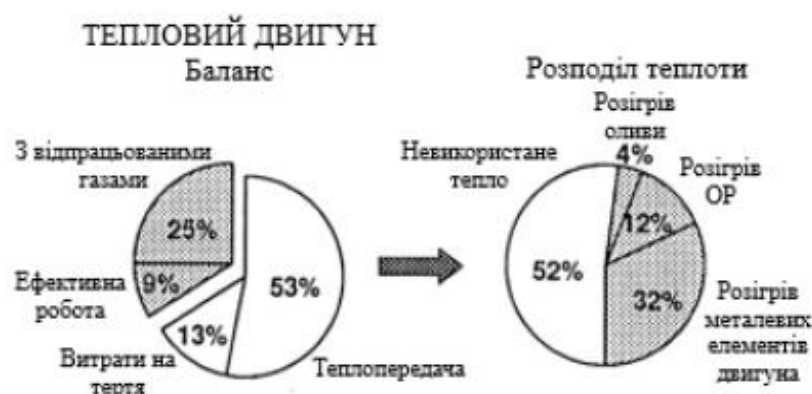
Рисунок 1.3 – Енергетичний баланс бензинового ДВЗ в режимі прогрівання.
