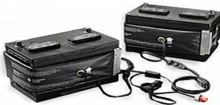
Рисунок 1.9 – Підігрів автомобільної акумуляторної батареї [11].
