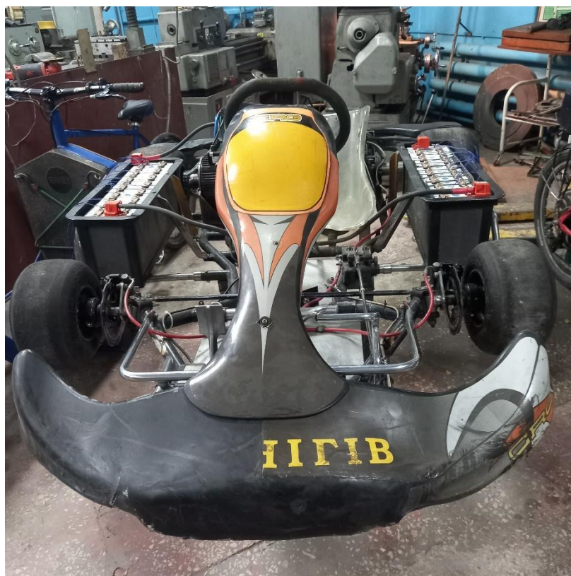
Рисунок 9 – Прототип електрокартингу високої потужності на стадії виробництва (вид спереду)
