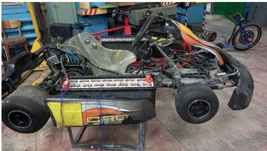
Рисунок 10 – Прототип електрокартингу високої потужності на стадії виробництва (вид збоку)
