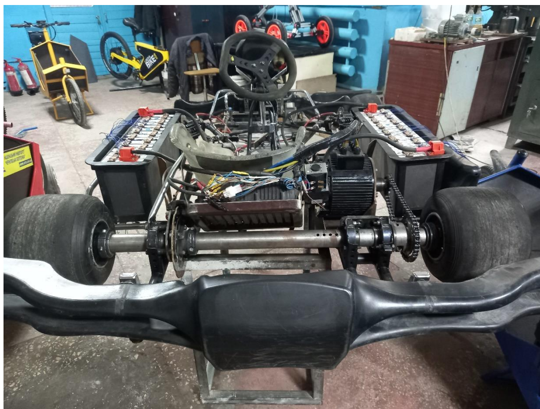
Рисунок 11 – Прототип електрокартингу високої потужності на стадії виробництва (вид ззаду)
