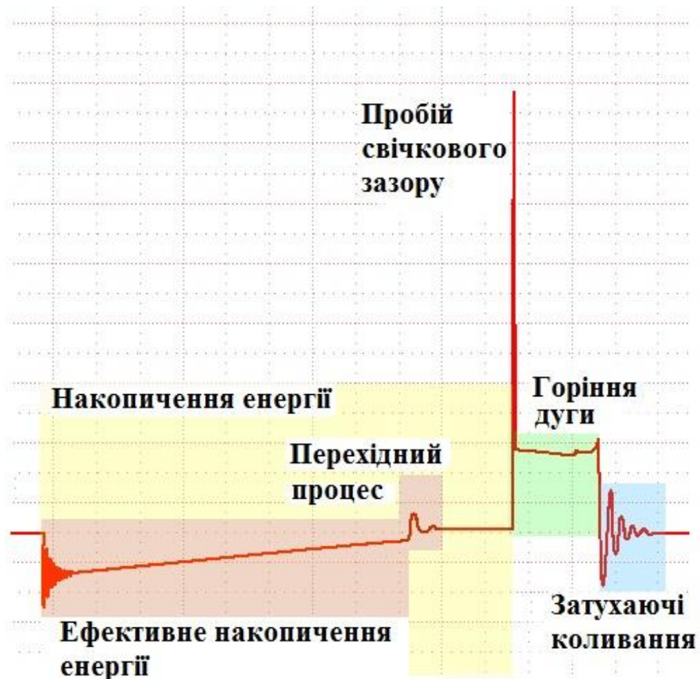
Рис. 2 – Осцилограма вторинної напруги справної системи запалювання
