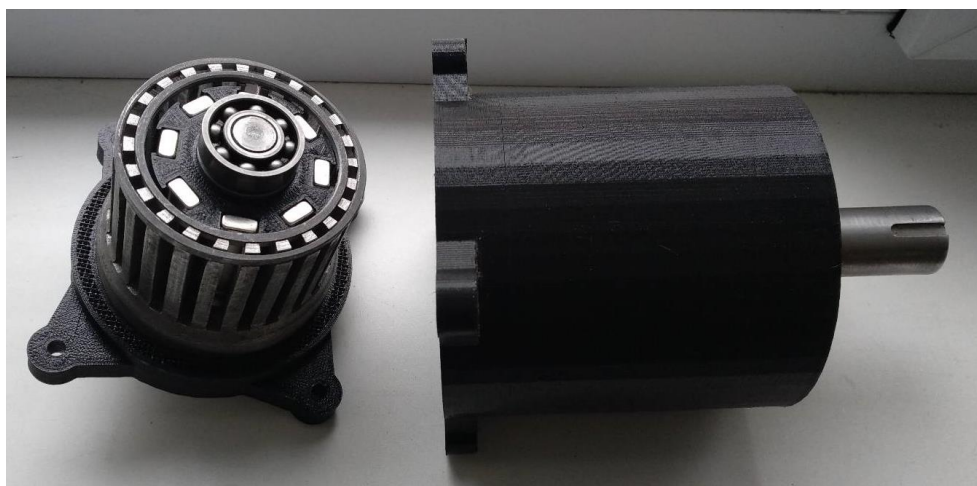
Рисунок 3.8. Кінематична модель магнітного редуктора виготовлена з застосуванням технологій 3D-друку
