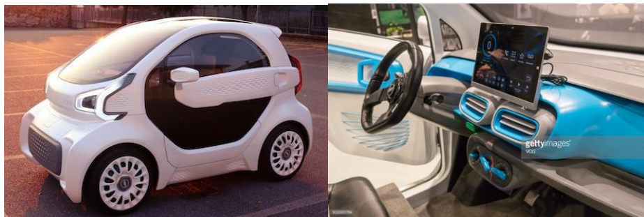
Рис. 1.3 LSEV – перший серійний автомобіль з використанням 3d друку
