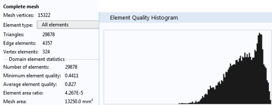
Рисунок 2.5 Розбиття геометрії моделі на трикутну сітку для кінцево-елементного рішення задачі та властивості сітки
