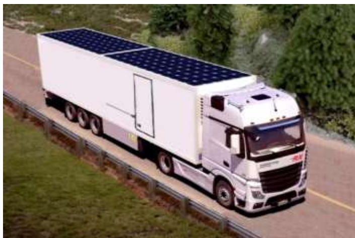
Рисунок 1.10 – Сонячні панелі, встановлені на дах напівпричепа-рефрижератора
