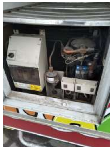
Рисунок 3.2 - Холодильна установка фургона Cold Car
