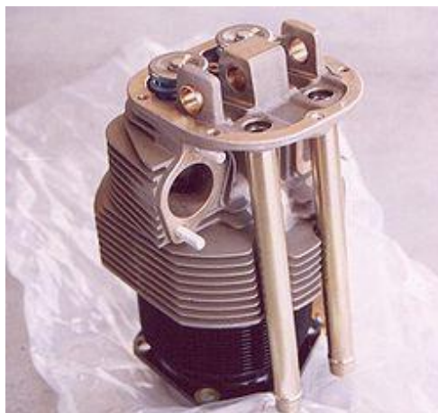
Рис. 3 – Система природнього повітряного охолодження
