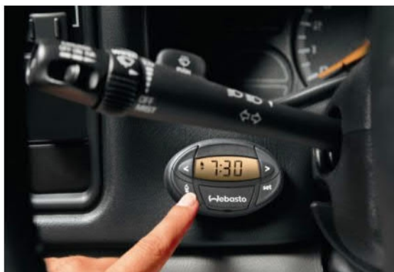
Рис. 4. Передпусковий підігрівач Webasto Thermo Top E (дизель) з можливістю встановлення таймеру і дистанційного пульта
