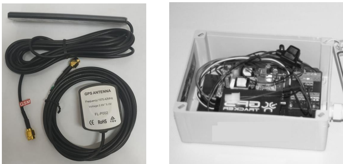
Рисунок 4 - Зовнішній вигляд бортового контролера з антенами
