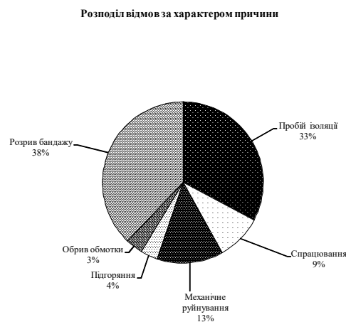
Рис. 10. 3. Вибір раціонального порядку заміन тягових електродвигунів ДК-722 на основі надійності їх роботи
