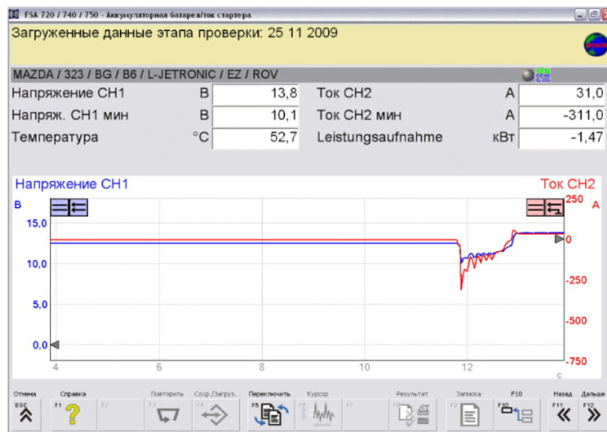
Додаток 1.34 - Результирующее окно этапа измерения «Аккумуляторная батарея: ток стартера»
