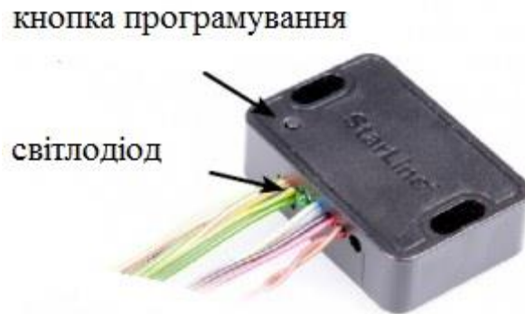
Рисунок 2.9 – CAN модуль автомобільної сигналізації StarLine
