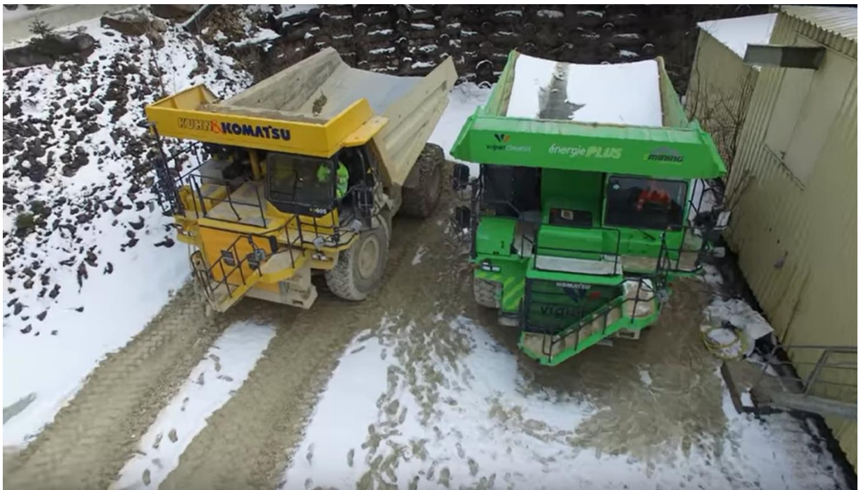
Рис. 4. Електросамоскиди Komatsu HD 605-7 (зліва) та eDumper (справа)
