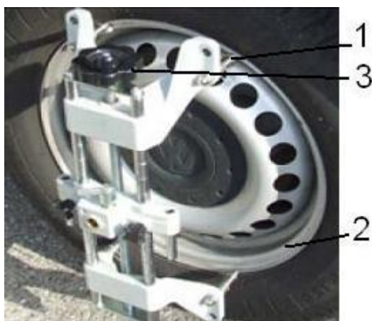
Рисунок 20 - Кріплення швидкозакимного фіксатора до бортової закраїни ободу
