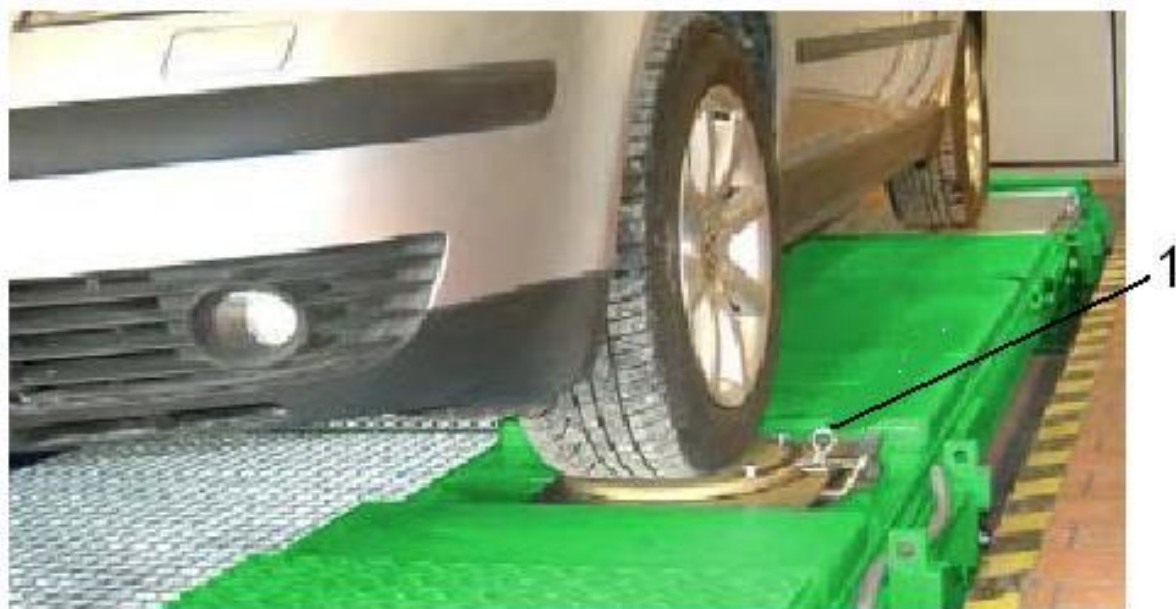
Рисунок 19 - Встановлення автомобіля на поворотні плати
