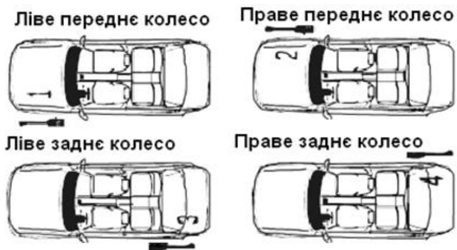
Рисунок 23 - Положення вимірювальних голівок
