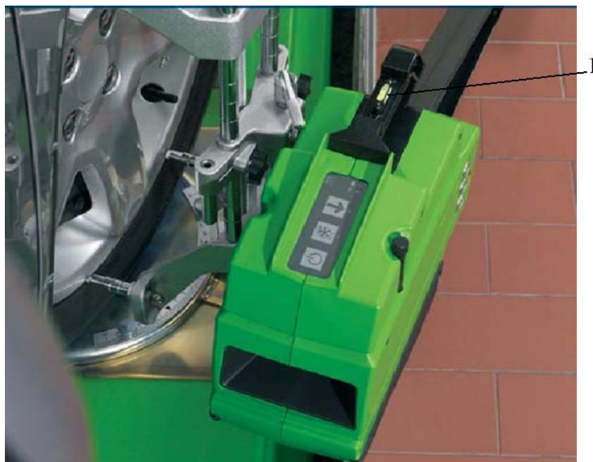
Рисунок 22 - Вирівнювання вимірювальних голівок:
