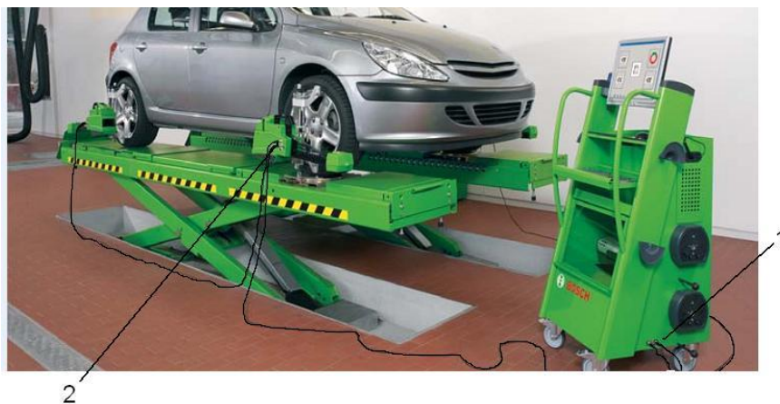
Рисунок 24 - Підключення вимірювальних голівок до вимірювальної стійки за допомогою з'єднувальних кабелів
