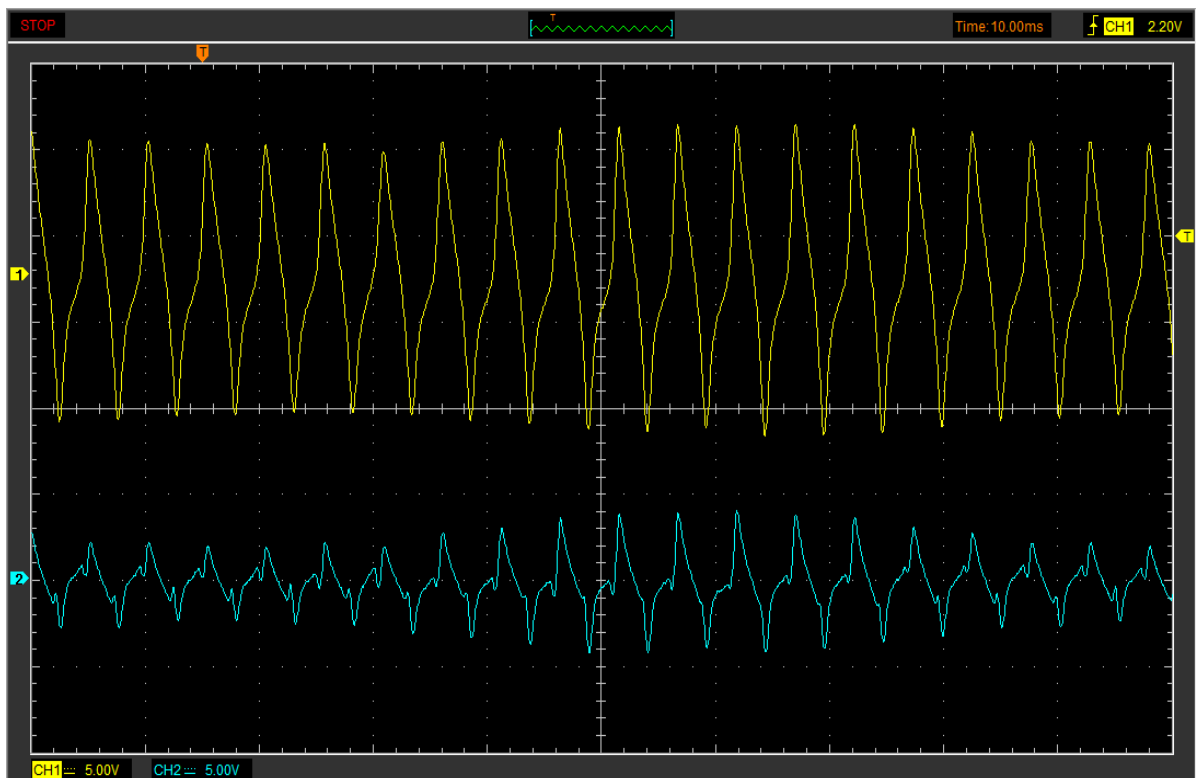
Рис. 3.7 Сигнал із двох сенсорів швидкості обертання колеса із різними повітряними зазорами.
