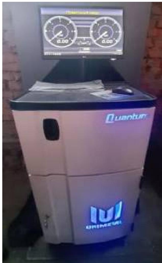
Рисунок 4.5 – Загальний вигляд центрального пристрою фіксування результатів вимірювання параметрів гальмування КТЗ та керування гальмовим стендом *Unimetal Quantum*
