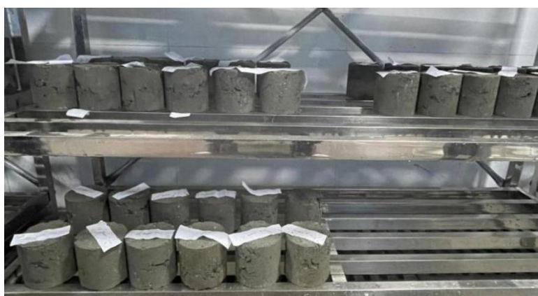
Рис. 3.18 – Загальний вигляд заформованих зразків в гідравлічній ванні
