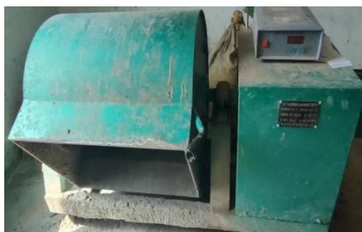
Рис. 3.15 – Лабораторна мішалка для приготування щебенево-піщаних сумішей з додаванням цементу та модифікуючих добавок
