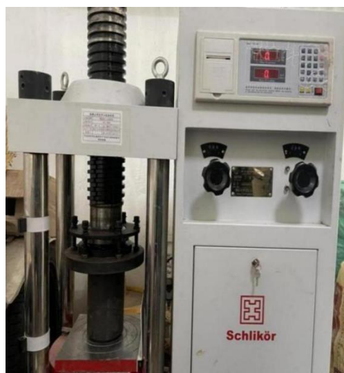
Рис. 3.16 – Гідравлічний прес для формування зразків-циліндрів
