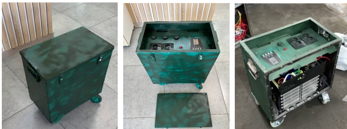
Рисунок 4.15 – Автономне пересувне джерело живлення для військових потреб, потужність гібридного інвертора - 3 кВт, ємність блоку накопичення – 9,1 кВт·год, габарити 420х340х300 мм
