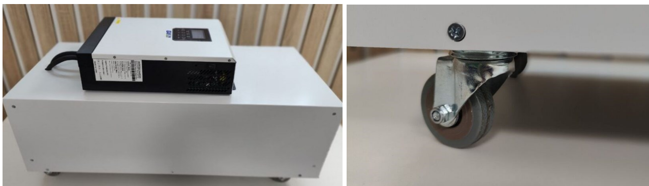
Рисунок 4.13 – Автономне пересувне джерело живлення, потужність гібридного інвертора 3 кВт і блок накопичення енергії на 10 кВт·год (36 МДж)
