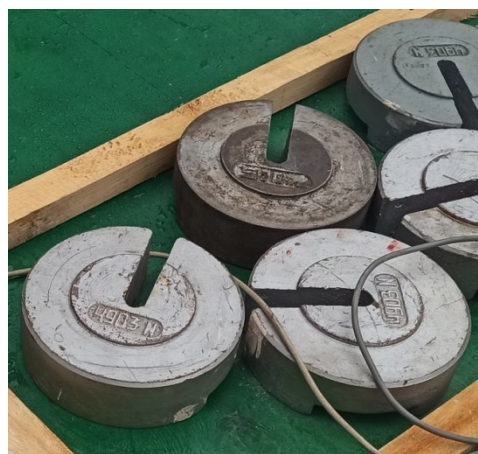
Рисунок 4.2 – Вантажі, що використовувались для зміни маси безпілотного колісного візка в процесі експериментального дослідження
