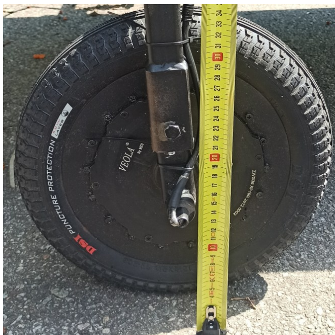
Рисунок 4.3 – Мотор-колесо VEOLA ZWG36 XF19R, що встановлені на безпілотний колісний енергомодуль
