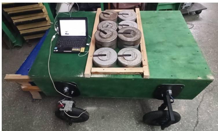
Рисунок 4.2 – Вантажі, що використовувались для зміни маси безпілотного колісного візка в процесі експериментального дослідження
