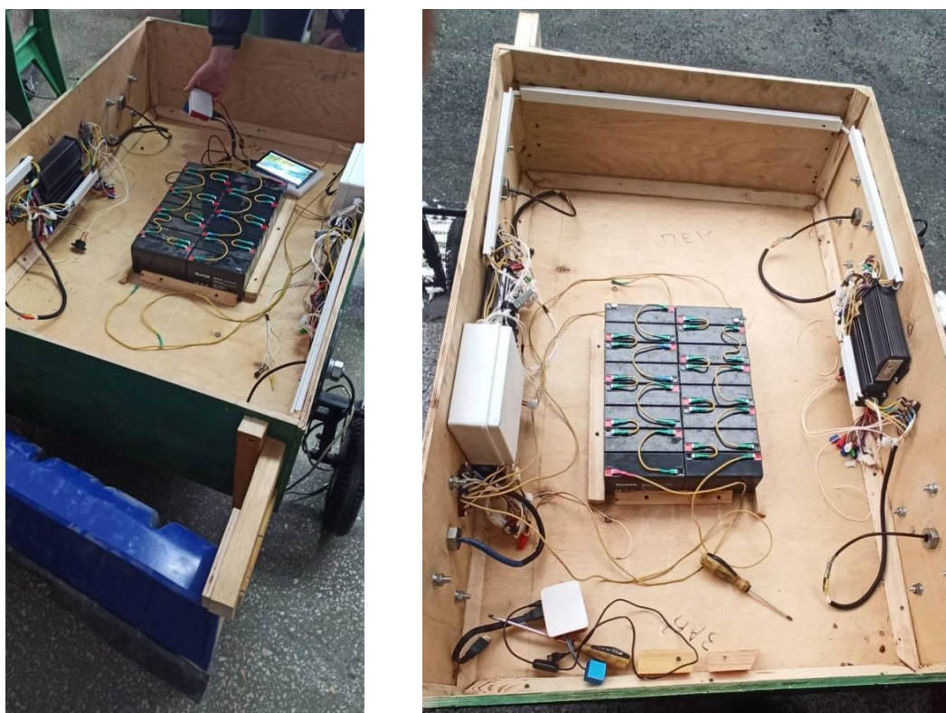
Рисунок 4.4 – Блок акумуляторних батарей та система керування безпілотного колісного візка
