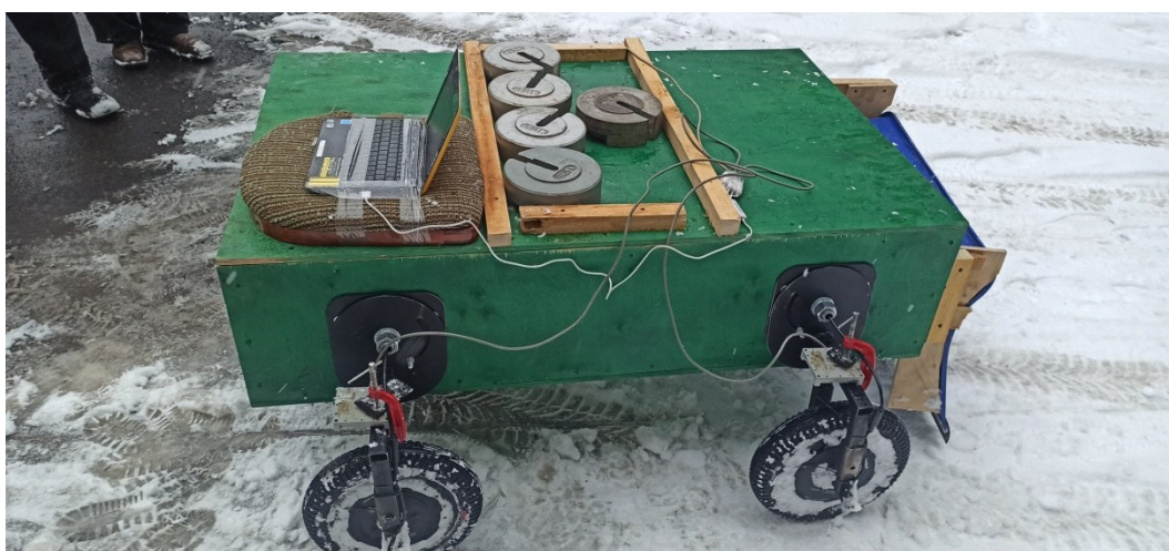
Рисунок 4.1 – Безпілотний колісний енергомодуль в процесі експериментального дослідження: а, б – без додаткового завантаження; в – з додатковим завантаженням
