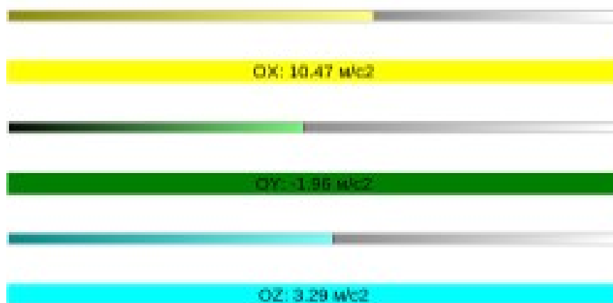
Рисунок 4.6 – Відображення сигналу акселерометра в режимі реального часу
